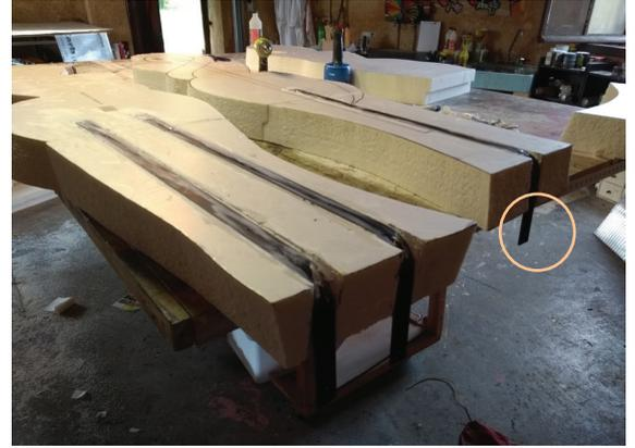
Taille et renforts métalliques dans la mousse polyuréthane. Les tiges au sol se prolongent pour donner stabilité, et le cas échéant, fixer la pièce.
